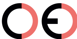
Marca CE falsa (demasiado separados)
